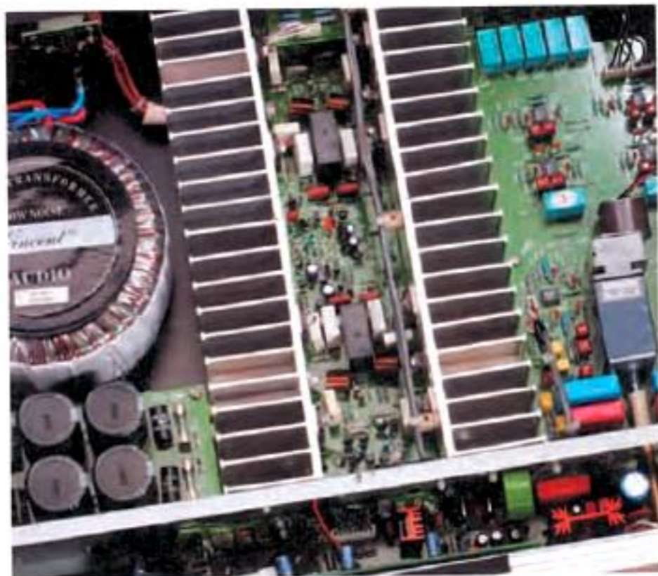
FÜRSTLICH: Eingangstufe, Endverstärker, Netzteil und Bediensteuerung arbeiten strikt getrennt in eigenen Abschirmkammern. Für den rechten und linken Kanal bereitet der Vincent jeweils eigene Speisespannungen auf.
