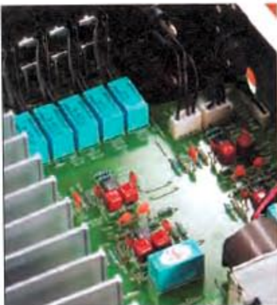
GROBER EMPFANG: Die Puffer-ICs rechts nehmen symmetrische, die linken Cinch-Eingangssignale an.
